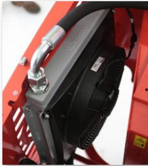
**Scambiatore di calore per olio idraulico**
